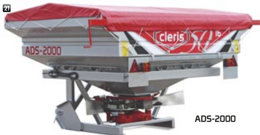
21 Toldo abatible, tipo camión, con arillos de chapa plegada Lorry type folding tarpaulin with folded sheet
