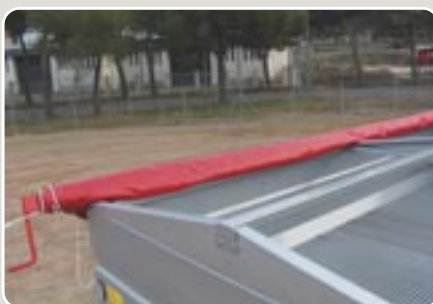
8 Toldo abatible, tipo camión, con arillos de chapa plegada Lorry type folding tarpaulin with folded sheet
