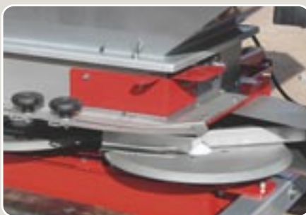
2 Discos, agitador y fondo de tolva de acero inoxidable. Grupo distribuidor TDC-540 Stainless steel discs, agitator and backdrop hopper. Gear distributing TDC-540
