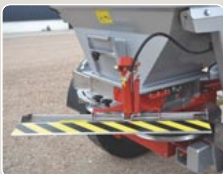
10 Bordeador BLS para trabajar desde el borde Border spreading system BLS for working from the border
