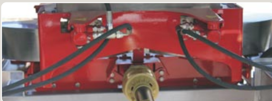
11 Doble mando hidráulico de apertura y cierre Double hydraulic driven feeding gate
