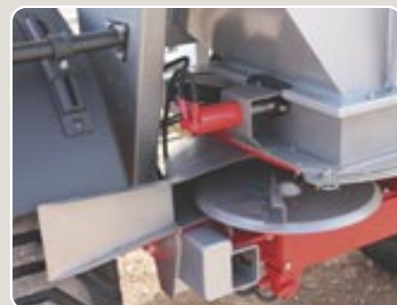
9 Discos, agitador y fondo de tolva de acero inoxidable. Grupo distribuidor TDC-540 Stainless steel discs, agitator and backdrop hopper. Gear distributing TDC-540
